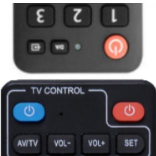
3. Ovladač od TV a ovladač od DIWAY k sobě přiblížíme naproti vysílacími LED na krátkou vzdálenost
